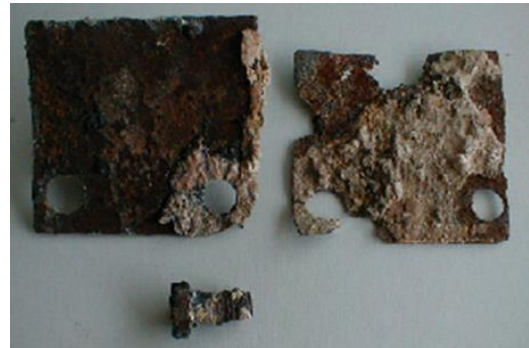
Probeta expuesta a un medioambiente altamente corrosivo – evaluación de efectividad de varios recubrimientos
